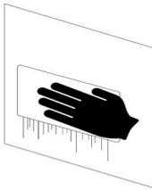
Шаг 2. Снять защищающую ленту с монтажной рамки.
